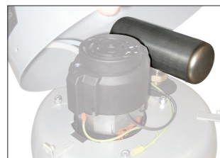
Filterabreinigung mit Druckluftspeicher
