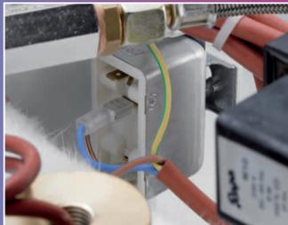
Das Sicherheitsthermostat schaltet die Heizung bei Übertemperatur ab.
