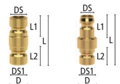
\*Stecknippel mit Zoll-Gewinde vernickelt zur einfachen Unterscheidung
