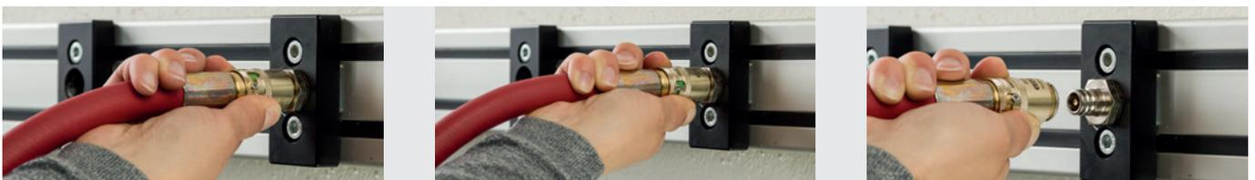
Das Entkuppeln erfolgt durch ein manuelles zwangsgeführtes Zurückschieben der Kupplungshülse. Erst durch eine bewusste Zieh- bzw. Drehbewegung kann der Stecknippel gelöst und von der Sicherheitskupplung entnommen werden.
