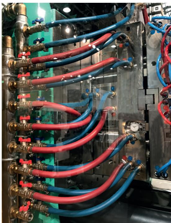
Kunststoffverarbeitende Betriebe sind auf besonders robuste und widerstandsfähige Kupplungen und Armaturen angewiesen. Der Grund: Sie kommen beim Kühlen und Heizen von Formaufbauten bei Spritz- oder Druckgussanwendungen zum Einsatz und müssen dort extremen Temperaturen standhalten.
