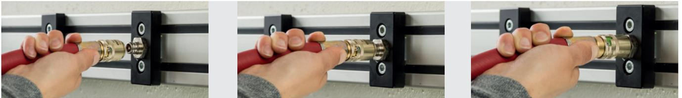
Einhandbedienung - Zur Verbindung einfach den Stecknippel in die Sicherheitskupplung eindrücken. Die Verriegelungshülse rastet dann aufgrund der automatischen Sicherheitsverriegelung mit einer Verdrehung von selbst nach vorn in die endgültige Sicherungsposition ein. Die Kupplung ist nun fest mit dem Stecknippel verbunden und gegen unbeabsichtigtes Öffnen gesichert.
