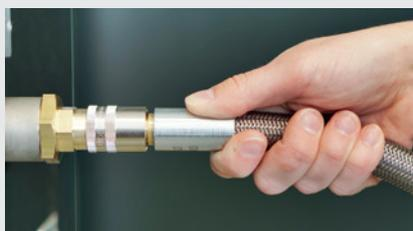
Das Entkuppeln erfolgt durch Zurückschieben der Kupplungshülse (mit automatischem Schließmechanismus bei absperrenden Kupplungen).
