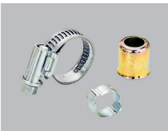
Zur Schlaucheinbindung von Armaturen können je nach Verwendungszweck, Medium, Druck oder Schlauchmaterial verschiedenste Einbindeverfahren von robusten Klemmen über leichte Schellen bis hin zu Presshülsen verwendet werden. Unterscheidungskriterien sind hierbei: Sicherheit der Einbindung, Lösbarkeit, Schnelligkeit und nötige Hilfsmittel zur Einbindung sowie Sauberkeit bzw. Anschluss von Verletzungsrisiko.
