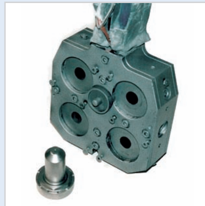
Nachher: Abrasivfreie Reinigung mit dem Softstrahlverfahren, ohne termische Beanspruchung der Bauteile
