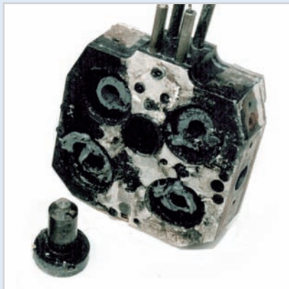
Vorher: Stark verschmutzte Heisskanalkomponenten nach dem Ausbau
